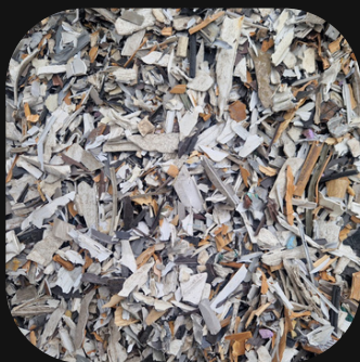
Okno je rozdrčeno na hrubší PVC frakci
