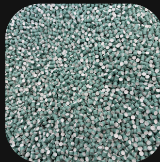
Z drti vzniká čistý PVC regranulát
